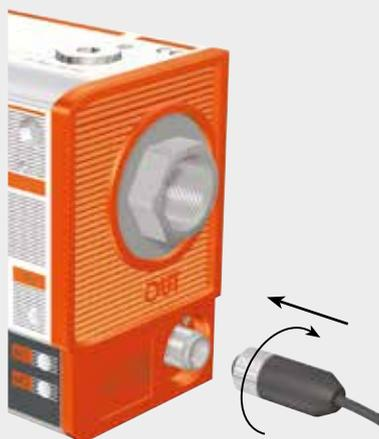
Para la electroválvula de apertura y el presostato se utiliza un conector estándar M12x1 de 5 polos con protección IP67. Sólo se requiere un cable, lo que aumenta la fiabilidad y reduce el tiempo de cableado.
