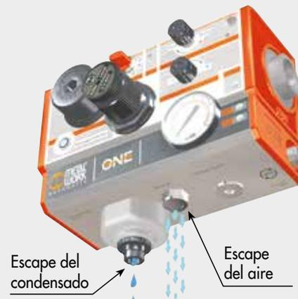
El aire del circuito se descarga mediante una salida en el lado inferior de la unidad equipada con silenciador. Si se desea transportar el aire de escape para evitar su emisión al ambiente, se puede sustituir el silenciador por una conexión conducida. (se recomienda una tubería con un diámetro mínimo de 6 mm) Junto a la salida de aire se encuentra la descarga de condensado que en la versión RA se puede conectar a la rosca con un racord de 1/8".
